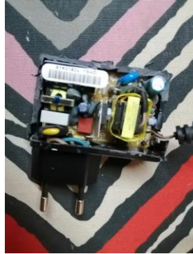
Figura 43. Imatge del transformador un cop obert.
