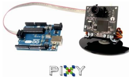
Figura 20. Càmera PixyCam connectada a la seva placa corresponent.
