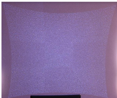
Figura 21. Patró de punts que projecta la càmera Kinect.
