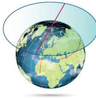
Figures 5 i 6: Projecció estereogràfica polar que ens permet visualitzar l'angle d'un meridià
