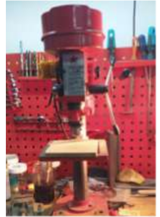
Font 60. Trepanant de sobretaula emprat per fer alguns dels talls i forats de les fustes
