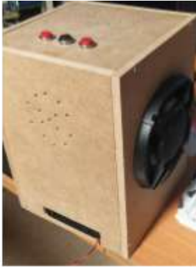
Font 68. Caixa Bass-Reflex amb tots els perifèrics connectats i disposats
