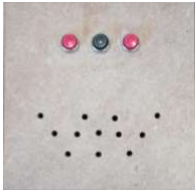
Font 59. Botons i forats per ajudar al micròfon a captar les ones sonores
