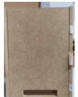
Font 57. Tall per encaixar la cara de l'ordinador on hi ha la connexió de la font d'alimentació
