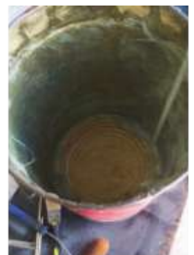
Font 62. Aplicació de la capa de resina al motlle cilíndric
