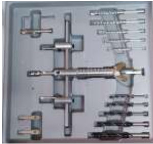
Font 54. Broca de corona ajustable que hem utilitzat per fer els talls circulars
