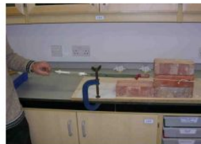
El "terratrèmol" del maó en acció – b) Ús d'un dinamòmetre per quantificar les forces implicades. S'evita l'esllavissament del maó frontal amb una llista, fixada a la taula per un sergent. (Fotos: P. Kennett)
