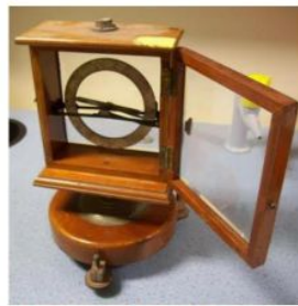
Un aparell, amb una agulla magnètica que gira en el pla vertical per mostrar la inclinació magnètica de la Terra (Foto: Suzy Allen/Gwyn Jones)
