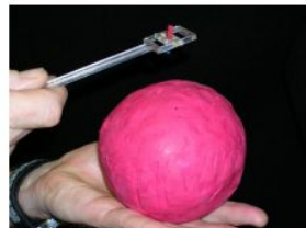
Un Magnaprobe™ suspès sobre el pol nord d'una barra magnètica amagada dins una esfera de Plastilina™. (Foto: Peter Kennett)
